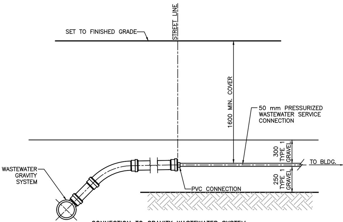
**CONNECTION TO GRAVITY WASTEWATER SYSTEM**
