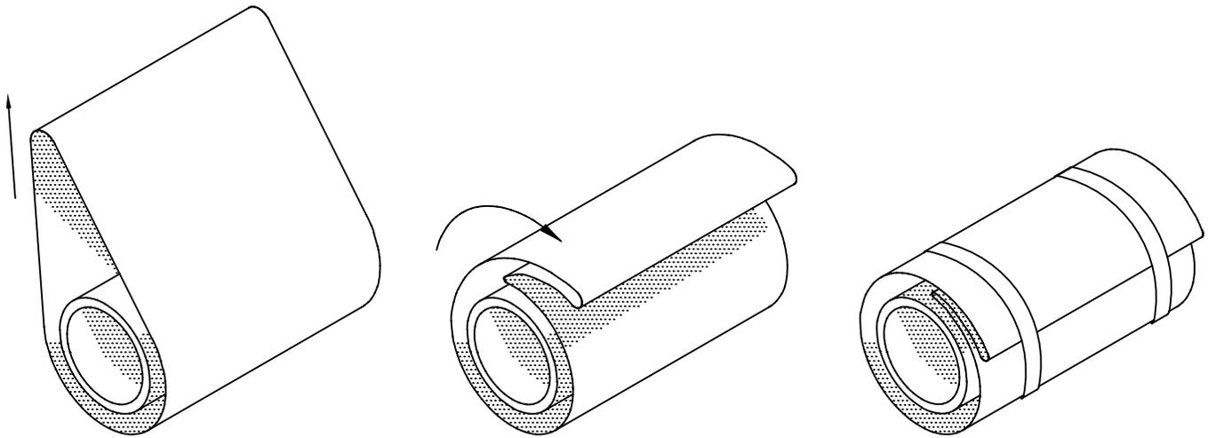
TAKE UP SLACK IN TUBE TO MAKE A SNUG, BUT NOT TIGHT, FIT. FOLD EXCESS BACK OVER TOP OF PIPE, SECURING THE FOLD AT QUARTER POINTS ALONG THE LENGTH OF THE PIPE.
